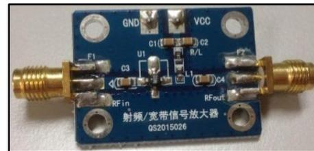
Fig. 10. LNA circuit
