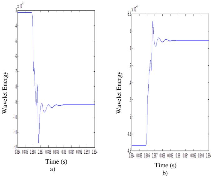
Fig. 6 Back to back capacitor switching at: a) MTA b) MTE
